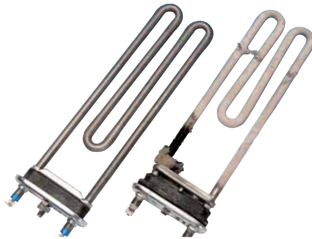
■ Kalk kann schwere Schäden verursachen. Links im Bild eine Heizspirale mit GRANDER®, rechts ohne GRANDER®.
