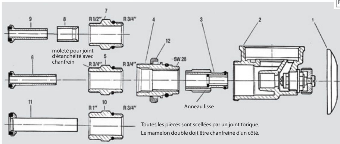
Attention: le vivificateur d'appartement ne peut être monté que verticalement vers le bas ou vers le haut. Horizontal seulement, s'il est en plus soutenu par un support. En tout cas, il devrait être sécurisé, pour ne pas être abîmé par un impact externe.
