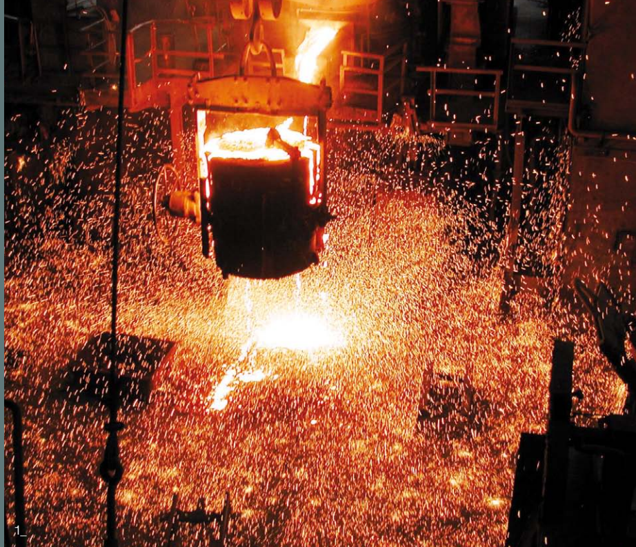
1_ Du métal en fusion se déverse d'un four à arc électrique.
